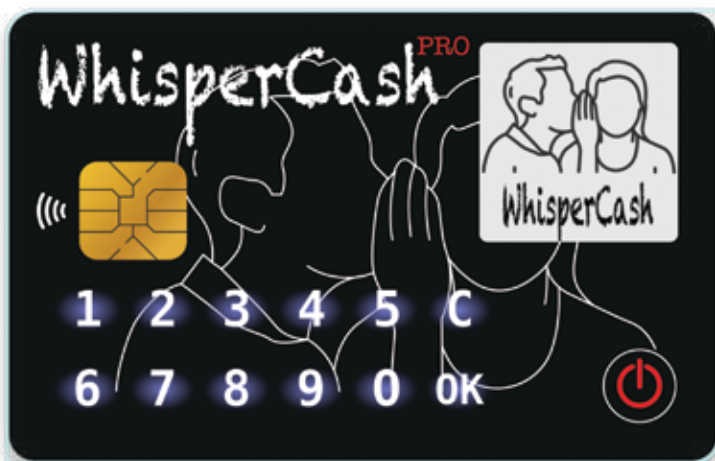
Dispositivo de WhisperCash del tamaño de una tarjeta de crédito. La empresa es la primera en crear una tarjeta a batería para realizar pagos sin conexión con una moneda digital de banco central.
